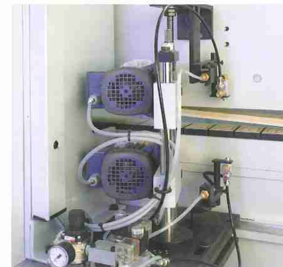
Schwabbelaggregat oben und unten mit Oszillation Zum Griffigmachen der Kanten mit Ausnutzung der gesamten Scheibenbreite.
