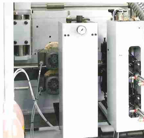
Finishbearbeitung FA 10 Bestehend aus Nachputzeinrichtung Leimfuge zur Leimrestentsorgung oben und unten an PVC-Kanten.
