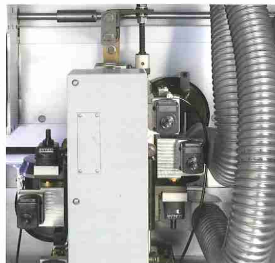
Multi-Nachputzeinrichtung MN 20 / MN 21 Zum Fasen oder Runden von bis zu 3 unterschiedlichen gefrästen PVC-Kanten.
