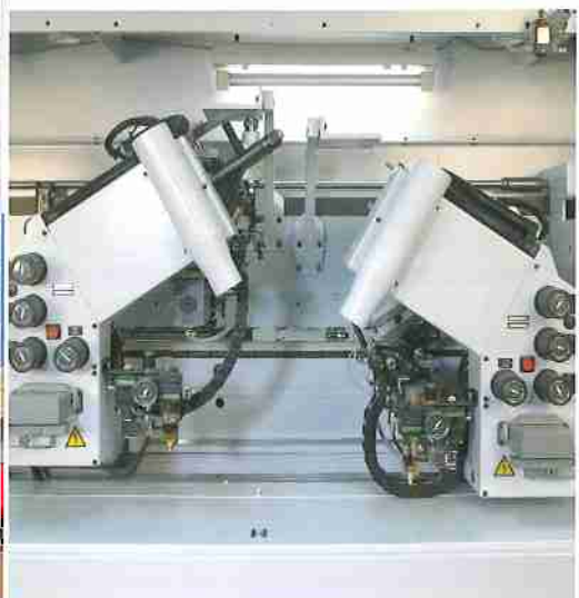
Formfräsaggregat FK 11/FK 13 Zum Bearbeiten der Kantenüberstände. Auch zum Umräsen der Vorder- und Hinterkante.*
